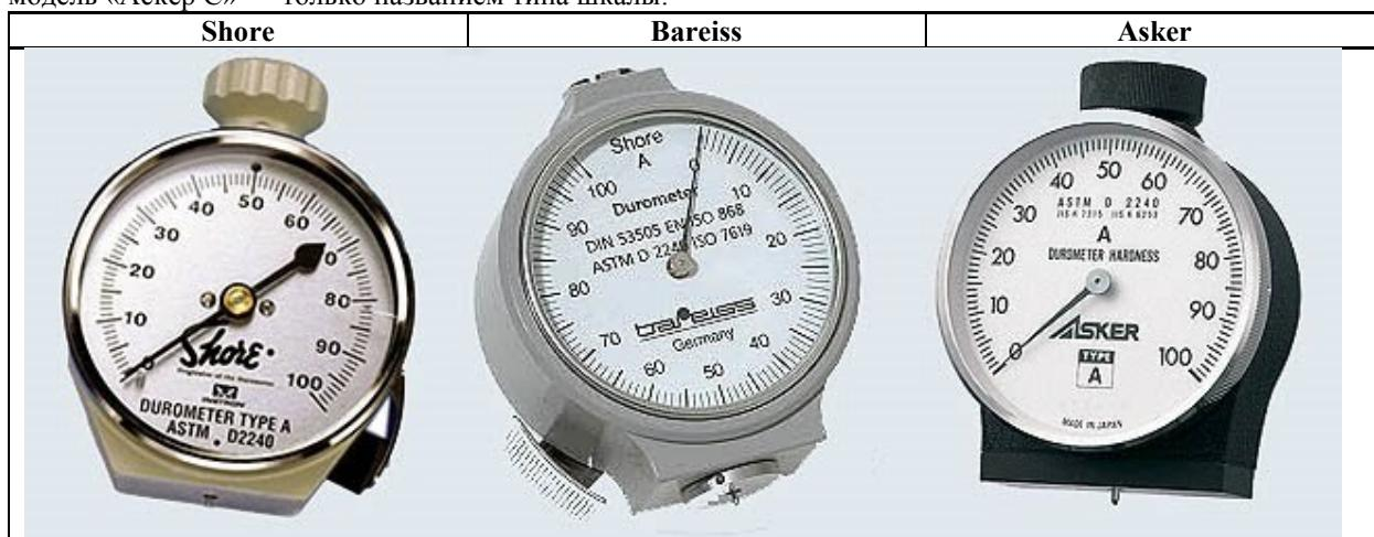
Шкалы твёрдости — первоначально дюрометры применялись для измерения твёрдости мягких резин, однако со временем возникла потребность измерять более твёрдые резины и пластмассы. А затем возникла потребность измерять ещё более мягкие резины, силикон и др. История развития шкал Шора следующая:
