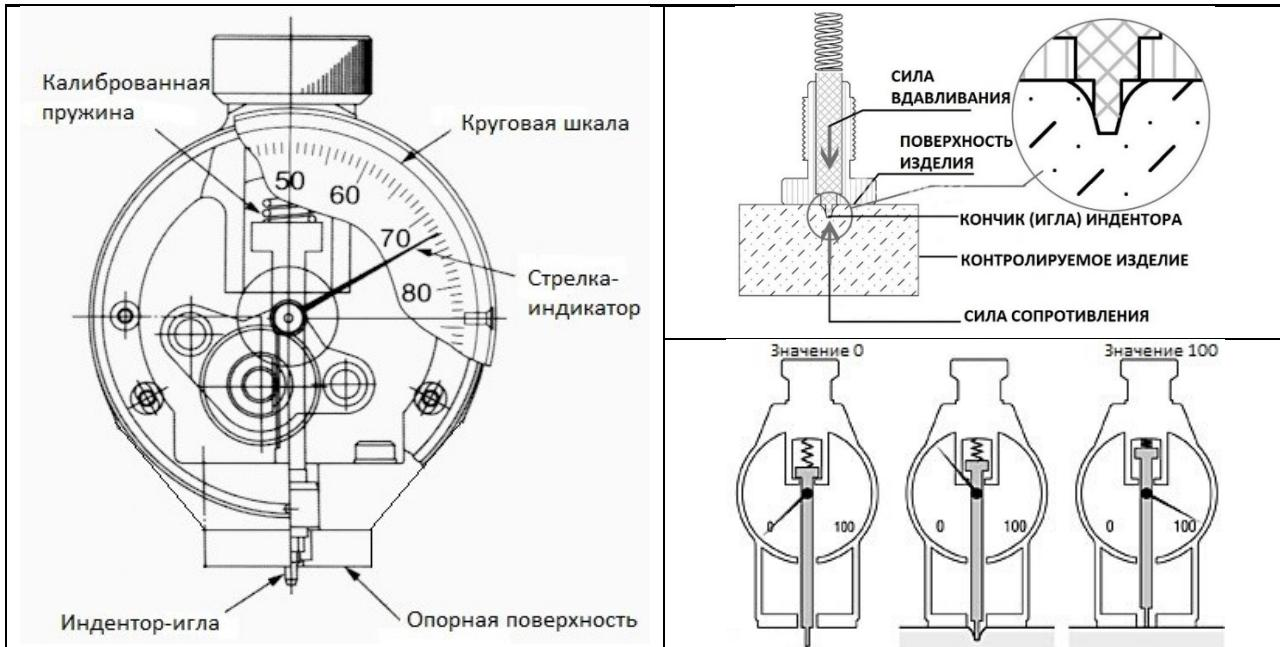
На получаемые результаты влияет форма индентора и прилагаемая к нему сила, поэтому между результатами, получаемыми при испытаниях с твердомером по шкале Шора тип А и твердомером по шкале Шора тип D, не может быть прямой зависимости.
