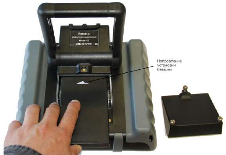
Рис 1-4 Установка нового аккумулятора
