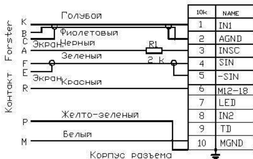
б) подключение ротационного датчика Forster
