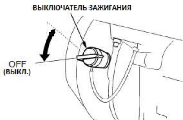
3. Поверните рычаг топливного крана в положение OFF (закрыто).
