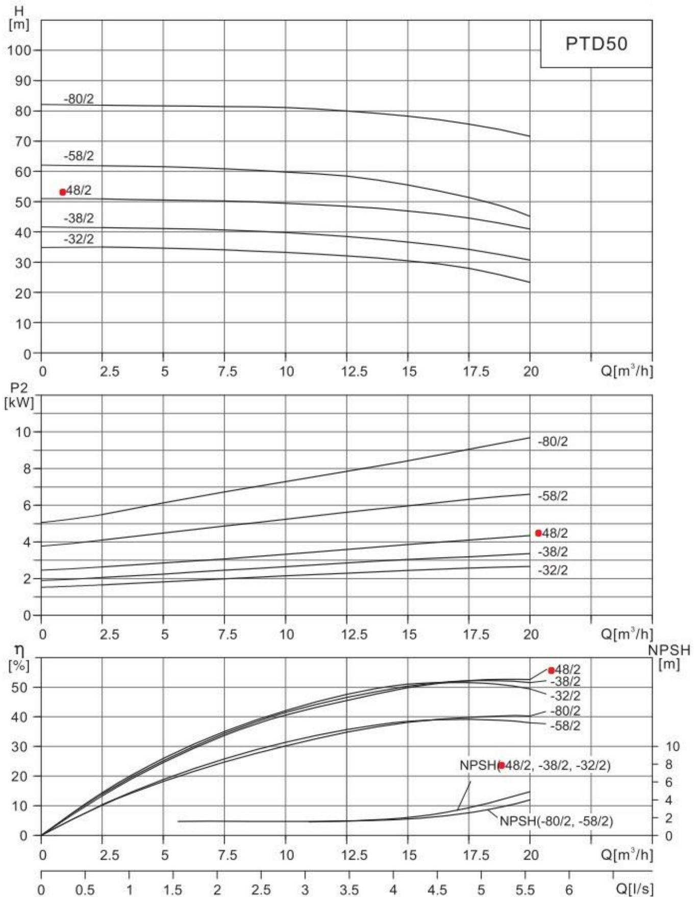
Пояснение к графикам:  $H(m)$  – напор в м.в.с.,  $Q(m^3/h)$  – подача в  $m^3/ч$ , NPSH – потери давления на всасывании,  $P_2(kW)$  – потребляемая мощность в кВт,  $\eta$  (%) – КПД в %. Измерения проводились для чистой воды, температурой  $20^\circ C$  и вязкостью  $1 \text{ мм}^2/с$
