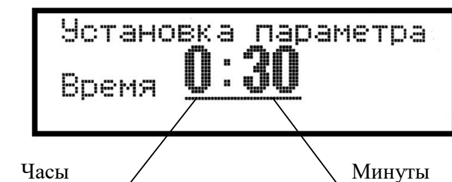
Рисунок 6 – Вид дисплея в состоянии задания времени нагрева
