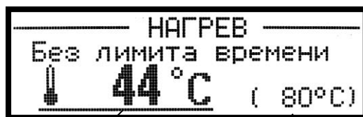
Рисунок 8 – Вид дисплея в состоянии нагрева без контроля времени
