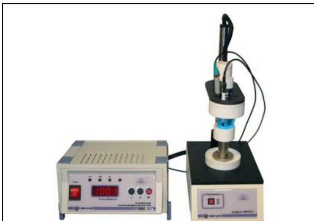
Рис.4 – Вольтамперометрический анализатор ABC-1.1 с одной электрохимической ячейкой (НТФ «Вольта», г.Санкт-Петербург)
