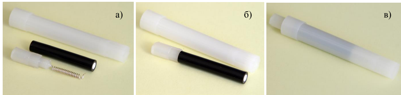
Рис. 21 – Внешний вид хлорсеребряного электрода (ХСЭ) и его колпачка: а) ХСЭ в раскрученном виде; б) ХСЭ в собранном виде; в) ХСЭ в собранном виде с одетым колпачком
