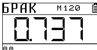
Рис.4-3 Срабатывание визуальной сигнализации брака
