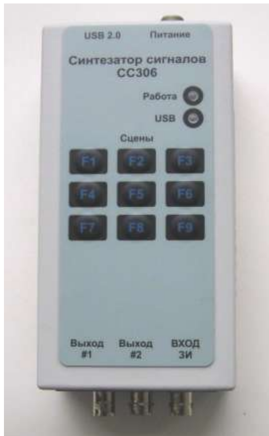
Рис.7.1. Верхняя панель СС306. Внешний вид. Органы управления и индикации.
