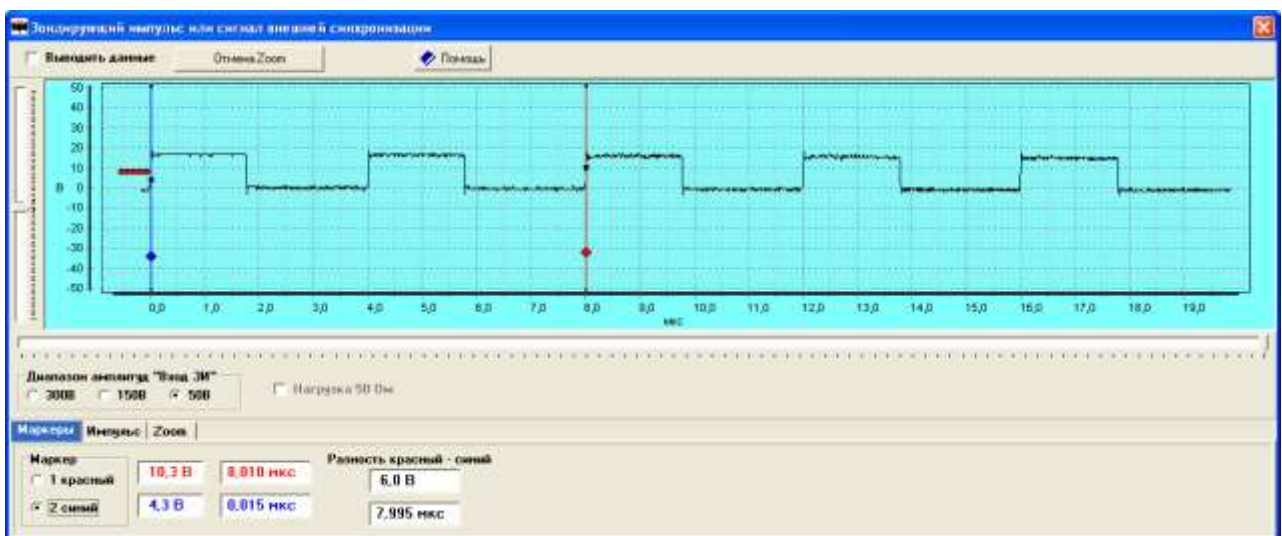
Рис.11.6.7.1. Определение погрешности измерения временных интервалов.
