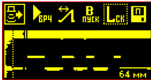
Рис.5.3.3.2. Пример В-скана. Преобразователь П111-5,0-К8.
