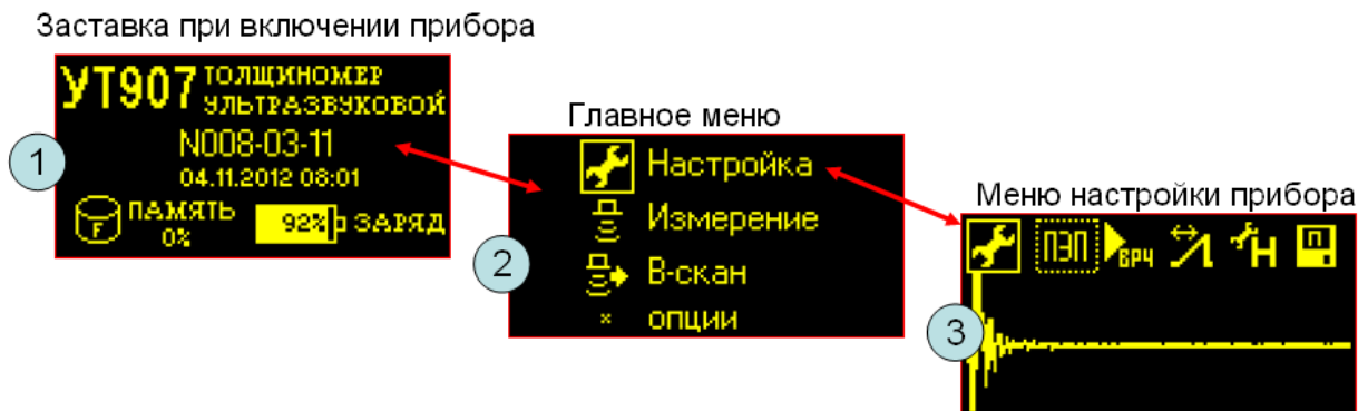
Рис.5.2.1. Переход в меню настройки прибора.
