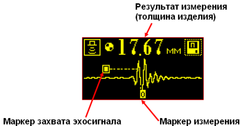
Рис.4.1.2. Способ измерения времени задержки эхосигнала по переходу через ноль.
