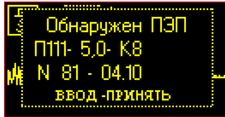
Рис.5.2.1.1. Результат считывания данных из ультразвукового преобразователя.
