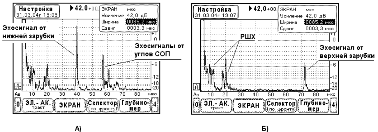
Рис. 9.4.2.2. Установка диапазонов отображения сигналов при контроле стыкового сварного шва. Эхосигналы в СОП толщиной 18мм. Зарубки 3,5*2,0 мм. Преобразователь П121-2,5-65°-Ø14. РШХ – реверберационно-шумовая характеристика преобразователя.
