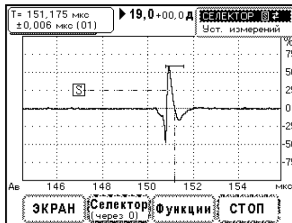
Рис.10.6.10.2. Вид заднего фронта маркерного импульса на экране прибора.
