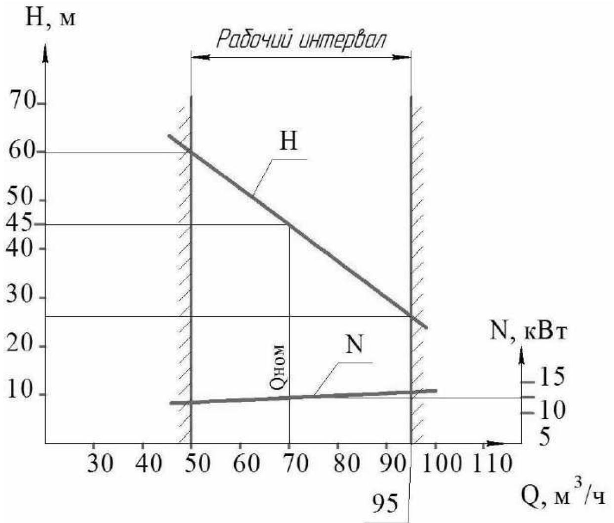
Рисунок 1 - Характеристики насоса ОДН 201-125-80, насосной установки
