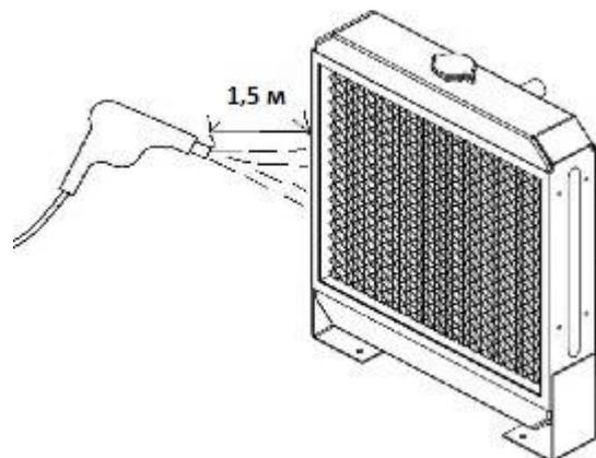
**ВНИМАНИЕ!** Опасайтесь попадания грязи в глаза при продувке сжатым воздухом. При работе со сжатым воздухом надевайте защитные очки.
