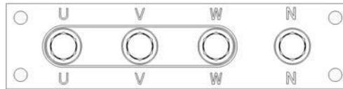
При запуске 3-фазного электродвигателя, если он вращается в обратном направлении, пожалуйста поменяйте местами любые два провода подключённых к силовым клеммам (см. рисунок).
