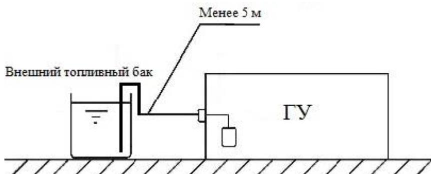
**ВНИМАНИЕ!** При использовании внешнего топливного бака, с некоторыми моделями ГУ, потребуется использование дополнительного топливного насоса.
