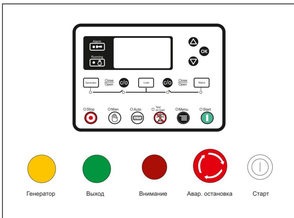
1. **Генератор** – лампа желтого цвета, светится при наличии напряжения на ГУ.
