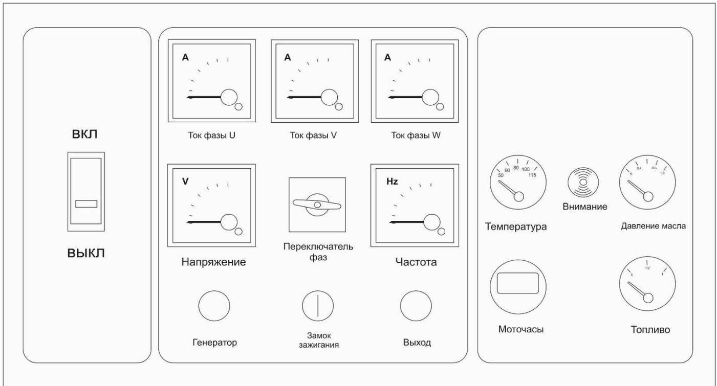
1. **Генератор** – лампа желтого цвета, светится при наличии напряжения на ГУ.
