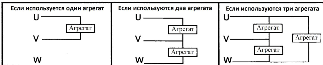
**ВНИМАНИЕ!** Входная мощность каждого агрегата не должна превышать 1/3 выходной мощности ГУ. Если возникнет перегрузка, обмотки альтернатора могут сгореть.
