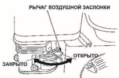
**Рычаг ВОЗДУШНОЙ ЗАСЛОНКИ** служит для открытия и закрытия воздушной заслонки в карбюраторе.
