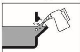
**Д) Рекомендованное масло для смазки:** Моторное масло для четырехтактного двигателя.
