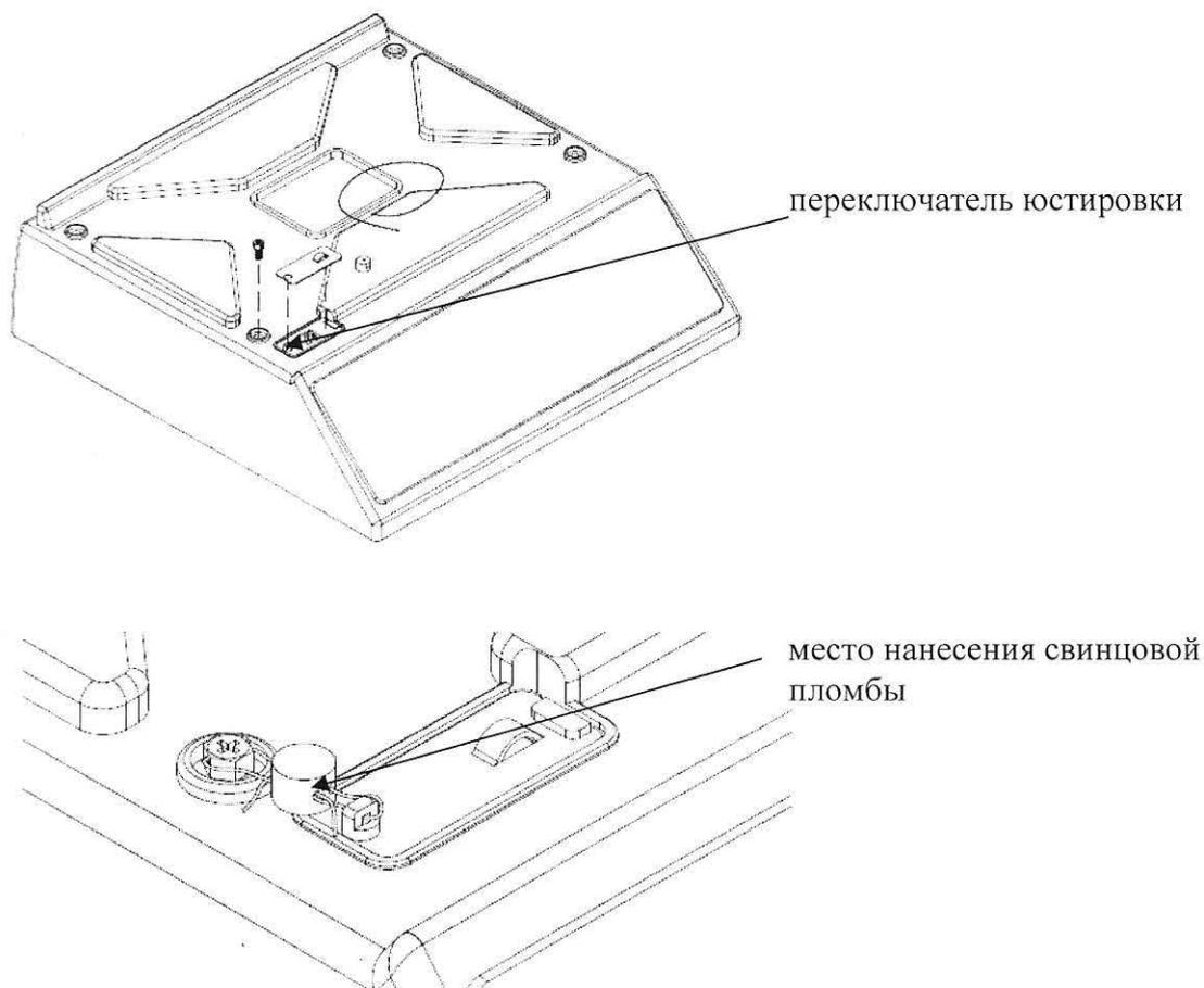
Рисунок 2 - Место пломбировки.
