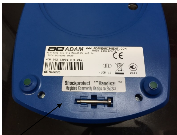
Рисунок 2 – Место нанесения защитной разрушаемой пломбы (наклейки)
