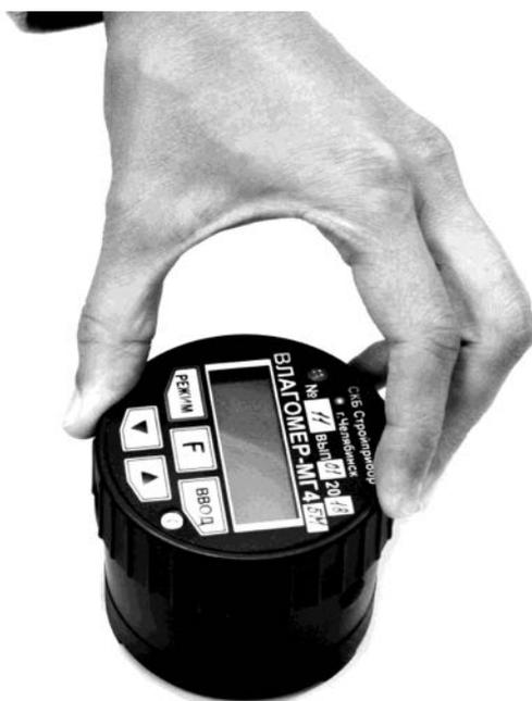
Рисунок 2 – Положение руки при проведении измерений
