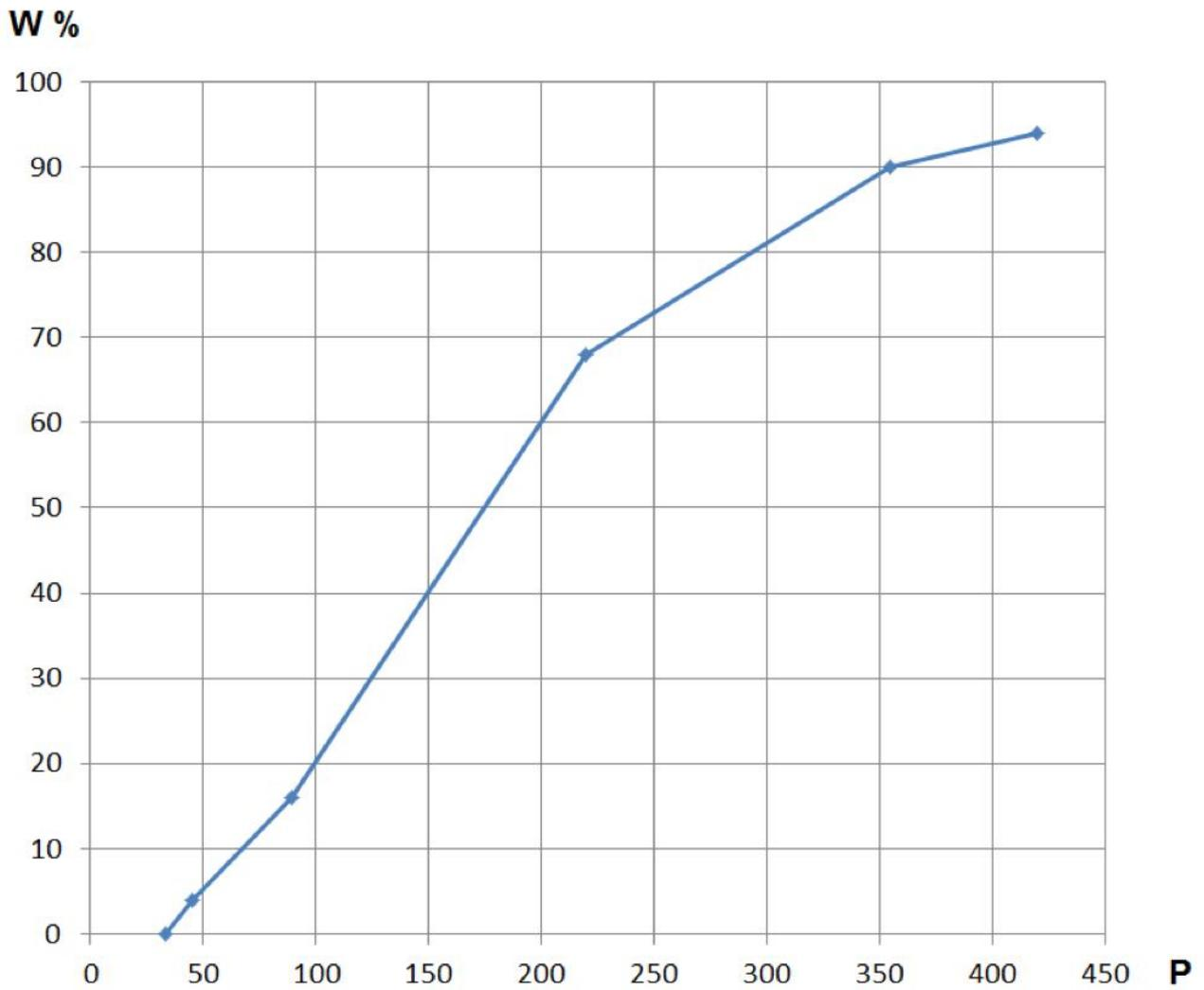
Графическое отображение установленной в точках Т1...Т5 градуировочной зависимости для материала «Ель»
