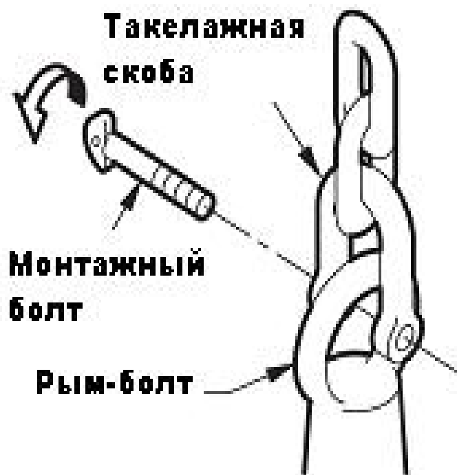
Рис. 3 Использование такелажных скоб
