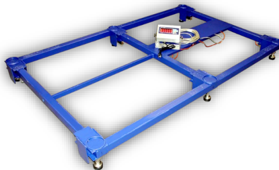
Весы с МАХ 15 тонн под емкость на 6-и опорах
