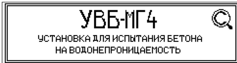
По истечении двух секунд блок управления перейдет в режим готовности к испытаниям. Дисплей блока управления примет вид:
