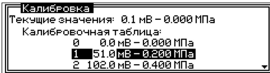
При входе в этот режим мигает младший разряд показаний датчика давления  $U$  в мВ. Нажать кнопку ↓ (↑) для изменения значения младшего разряда. Для переключения на следующий разряд, кратковременно нажать кнопку **РЕЖИМ**. Изменения значений следующих разрядов происходит аналогично.
