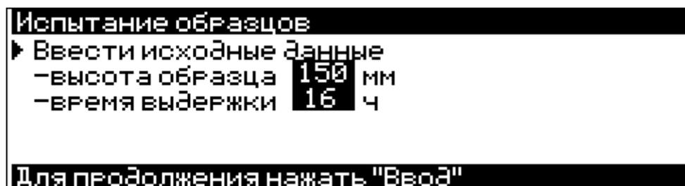
Время выдержки на каждой ступени однозначно определяется высотой образца.
