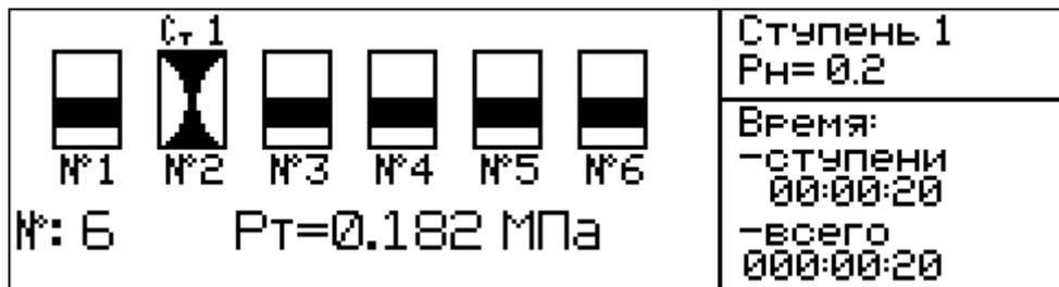
В данном примере произошло промокание образца №2 на первой ступени. Ступень, на которой произошло промокание образца, выводится над пиктограммой.
