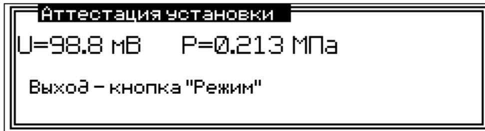
В режиме «Аттестация установки» управление двигателем водяного насоса производится только в ручном режиме (кнопки **ПУСК**, **СТОП**). Для обеспечения равномерного роста давления воды в системе с увеличением давления воды обороты двигателя автоматически уменьшаются. После достижения давления 1,0 МПа обороты двигателя водяного насоса будут минимальными.
