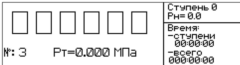
2.3.1.2 Для изменения номера серии испытаний (в случае необходимости) нажать кнопку **ВВОД** и удерживать ее в течении трех секунд. Кнопками ↓ (↑) изменить младший разряд номера. Для перехода к старшему разряду номера кратковременно нажать кнопку **РЕЖИМ**. Для фиксации результата и выхода из режима настройки нажать кнопку **ВВОД**.
