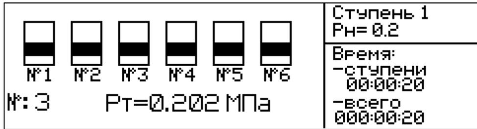
На дисплее размещаются 6 пиктограмм, соответствующим датчикам влажности. Если датчик влажности сухой, то пиктограмма изображается с движущейся горизонтальной полоской. Если произошло промокание образца, то пиктограмма становится статической. Дисплей блока управления примет вид, например:
