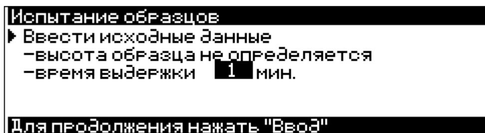
При помощи кнопок ↓ (↑) установить время выдержки на каждой ступени (от 1 до 30 минут) и нажать **ВВОД**.
