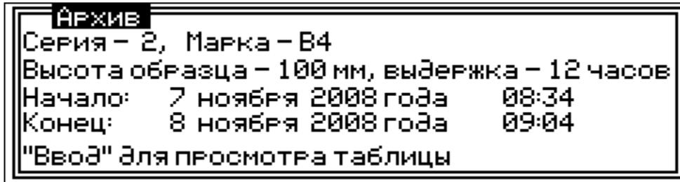
2.3.3.2 Для просмотра подробных данных по срабатыванию каждого датчика, кратковременно нажать кнопку **ВВОД**. Дисплей блока управления примет вид, например:
