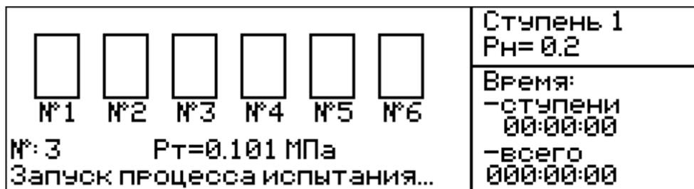
Отсчёт времени при запуске процесса испытания не производится. В этом режиме производится индикация текущего давления P<sub>T</sub>. Установка перейдёт в режим испытания, когда давление достигнет номинального значения первой ступени (P<sub>H</sub> = 0.200 МПа). Одновременно с началом режима испытания включается отсчёт времени.
