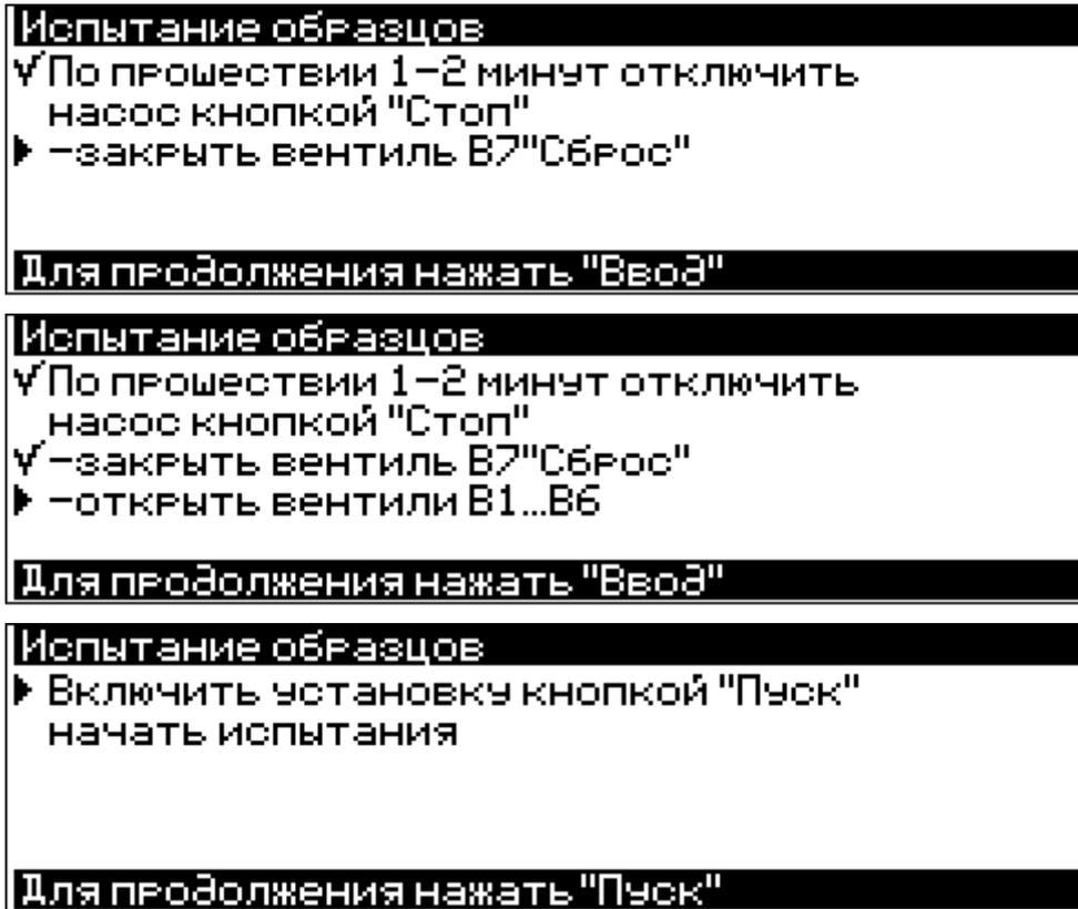
Нажать кнопку «Пуск». После включения электродвигателя водяного насоса установки, блок управления перейдёт в состояние запуска испытания, дисплей блока управления примет вид, например:
