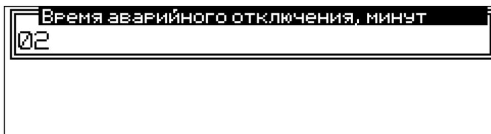
Кнопками ↓ (↑) установить время до аварийного отключения насоса и нажать **ВВОД**.
