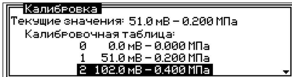
2.3.8.2.8 Кнопками **ПУСК** и **СТОП**, а так же вентилем В7 установить по образцовому манометру давление следующей ступени. Повторить п.п. 2.3.8.2.6, 2.3.8.2.8 для настройки калибровочной характеристики для остальных ступеней давления.
