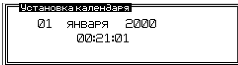
После входа в данный режим отображаются текущие дата и время. Для изменения даты и времени нажать кнопку **ВВОД**. Блок управления переходит в режим коррекции - мигает первая настраиваемая позиция - «Год». Кнопками ↓ (↑) изменить значение года. Год может быть установлен в пределах от 2000 до 2099.
