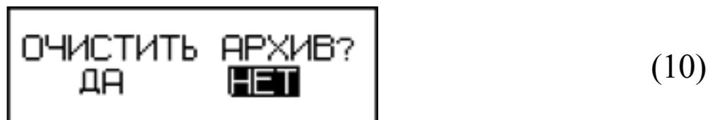
Нажатием кнопок  $\uparrow$ ,  $\downarrow$  переместить инверсное поле на требуемый пункт «**ДА**» и нажать кнопку **ВВОД**, прибор при этом возвращается в основное меню к экрану (1) «**Режим**». При выборе пункта «**НЕТ**» прибор возвращается в режим «**Архив**» к экрану (8).
