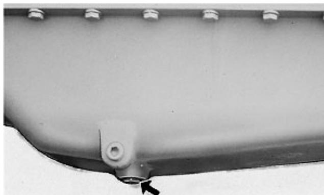
Пробка сливного отверстия поддона картера
