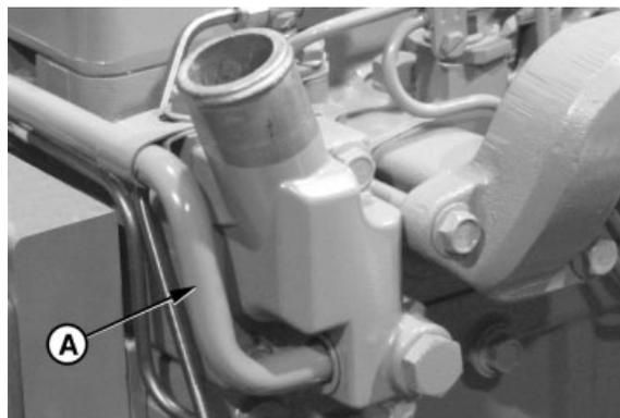
Трубка от крышки термостата до водяного насоса
