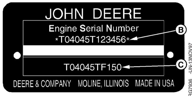
Табличка с серийным номером двигателя, изготовленного в г. Дубьюк
