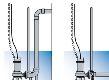
Установка с донным соединительным устройством
