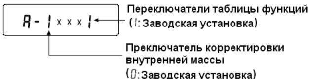
Установите переключатели таблицы функций и корректировки внутренней массы в положение 1, как показано на рисунке выше, с помощью следующих клавиш:
