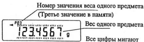
4. Выберите номер значения массы образца с помощью следующих клавиш: **RE-ZERO** - Используется для увеличения номера значения массы образца на единицу
