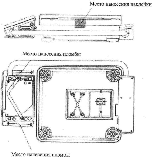
Рисунок 2 – Схема пломбировки весов
