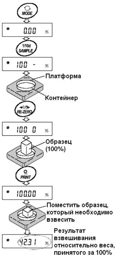
точки зависит от значения массы стандартного образца). Значение массы стандартного образца сохранится в памяти даже после отключения адаптера.
