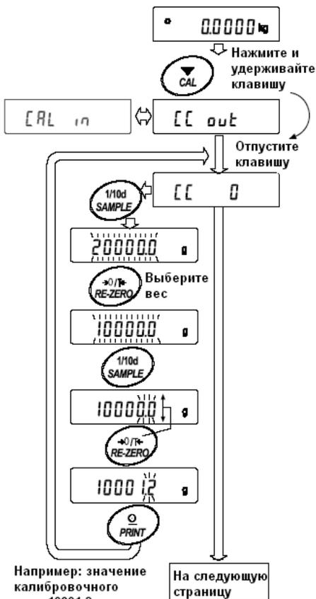
**Замечание:** В весах серии GP "цифра" соответствует дискретности взвешивания.
