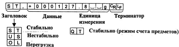
Этот формат используется, когда периферийные устройства не могут получать данные в формате A&D. Если используется принтер AD-8121, установите для него режим MODE 3.
