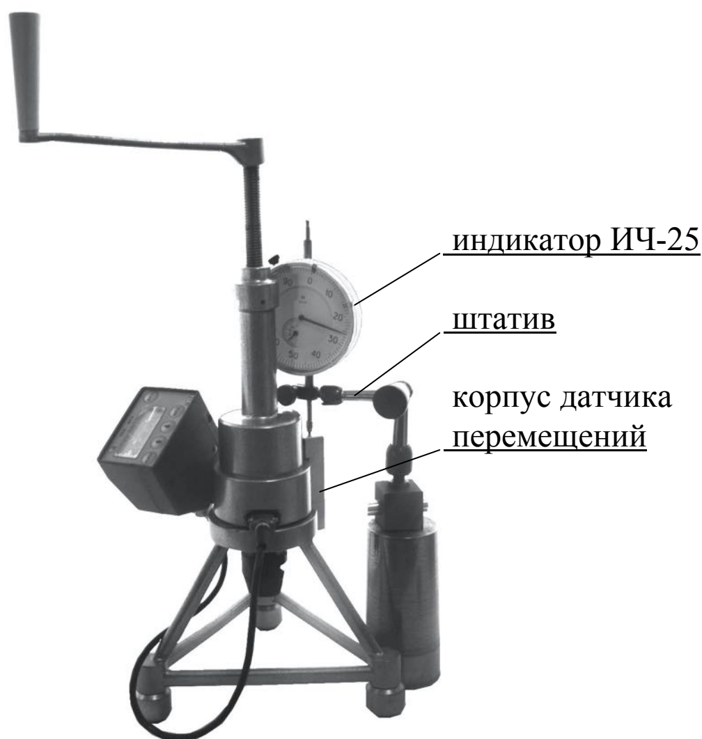
Рисунок 13 – Проверка датчика перемещений
