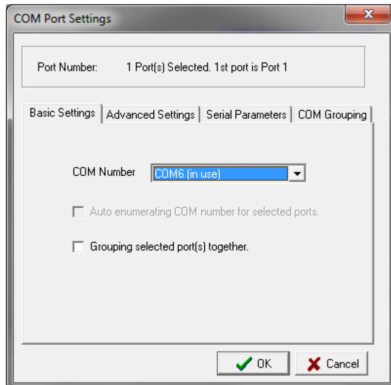
Теперь нажимаем Apply и наш порт добавлен. Параметры порта должны совпадать с параметрами, заданными в конфигурации подключенных к преобразователю весов. Для конфигурирования порта весов обращайтесь к Руководству пользователя.
