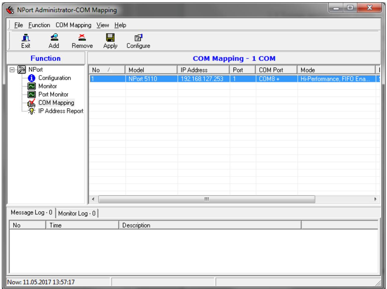
Нажимаем Configure и задаем параметры порта – номер, скорость обмена, контроль четности и т.д:
