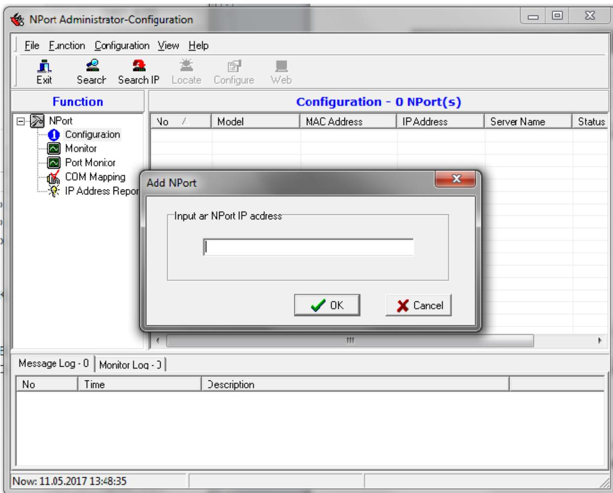
После обнаружения преобразователя необходимо отметить его и нажать кнопку Configure. Появится окно, на вкладке Network которого можно произвести изменение IP адреса преобразователя.
