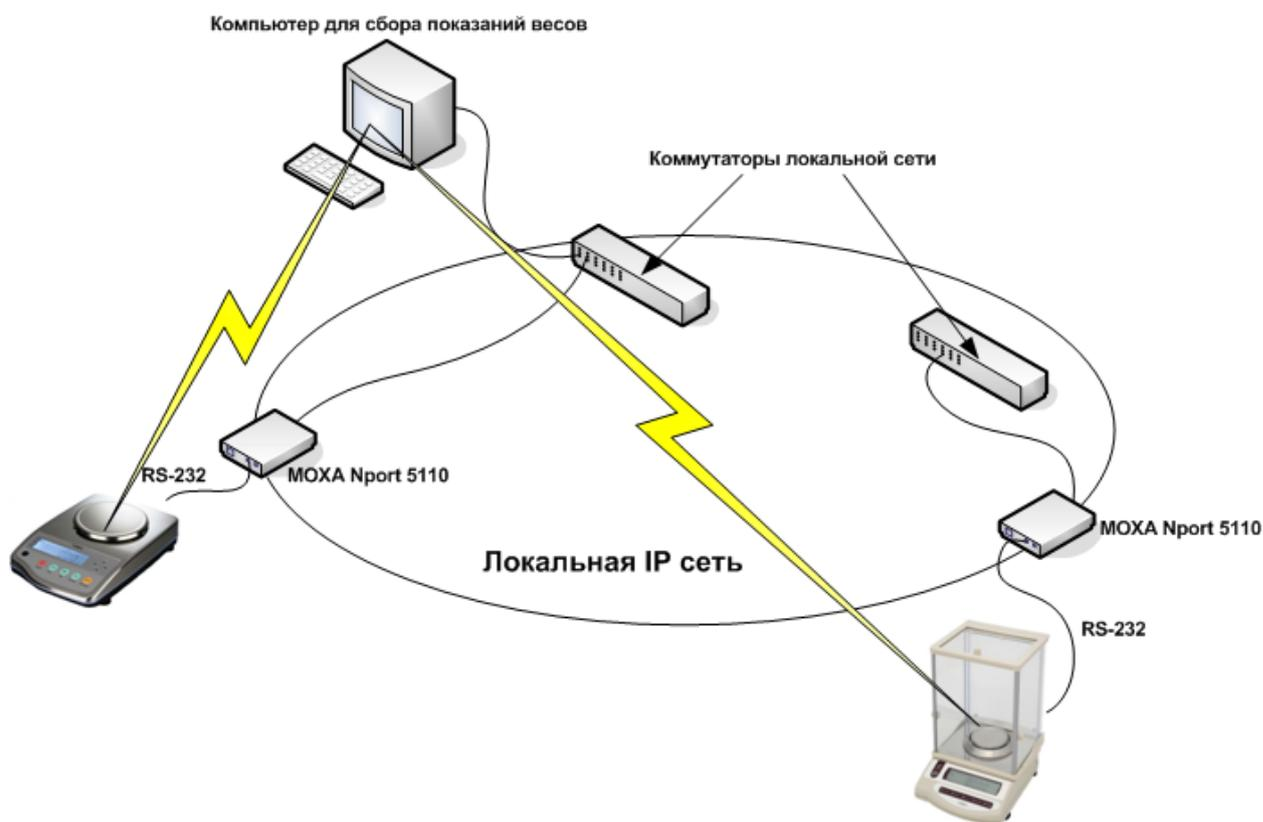
1.2. Перед началом работы необходимо на компьютер, предназначенный для опроса весов, установить программное обеспечение, поставляемое с преобразователем Moxa Nport 5110.
