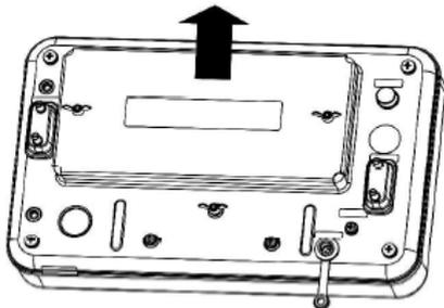
(1) Установите крышку батарейного отсека и зафиксируйте её болтами.
