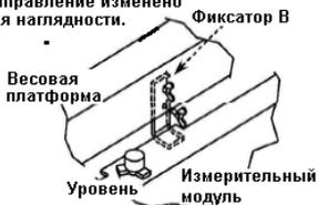
(1) Снимите фиксаторы А и В.
