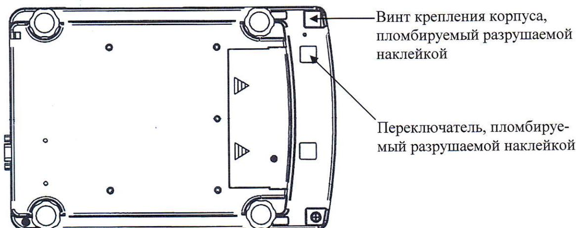
Рисунок 2 - Схема пломбировки весов от несанкционированного доступа
