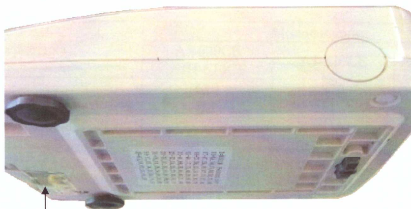
Место размещения пломбы (переключатель юстировки)
