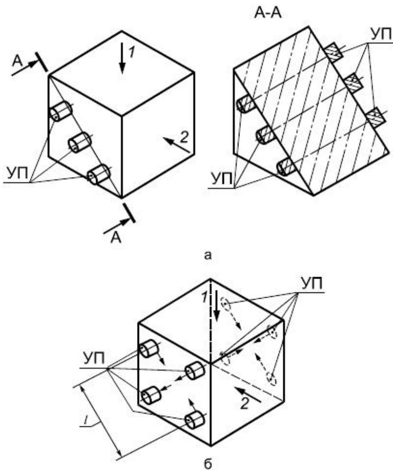
а - схема испытания образцов-кубов способом сквозного прозвучивания; б - схема испытания образцов-кубов способом поверхностного прозвучивания; УП - ультразвуковые преобразователи;  $l$  - база прозвучивания; 1 - направление формования; 2 - направление испытания при сжатии
